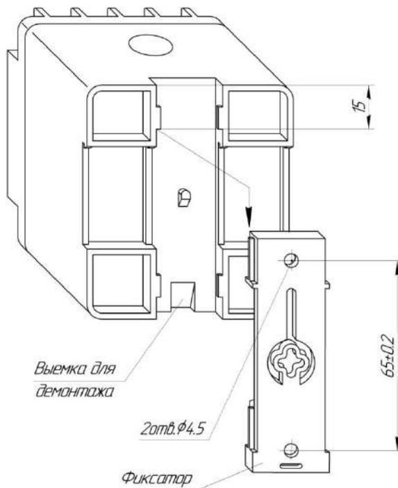
Рисунок Г.2 – Вариант крепления к панели
