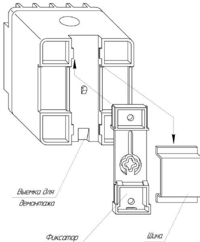
Рисунок Г.1 – Вариант крепления на монтажную рейку
