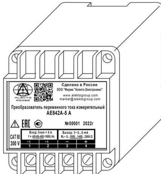
Рисунок 1.1 – Общий вид преобразователя модификации АЕ842А, АЕ842С с номинальным током до 5 А включительно
