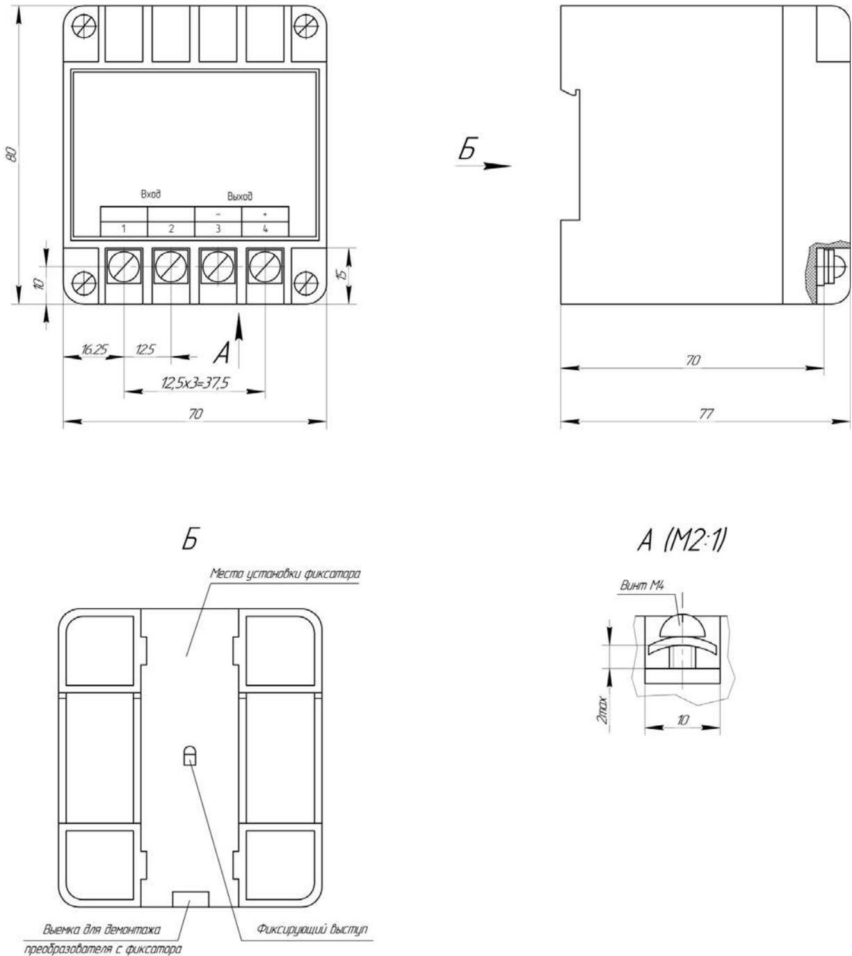
Рисунок В.1 – Преобразователь модификаций АЕ842А, АЕ842С
