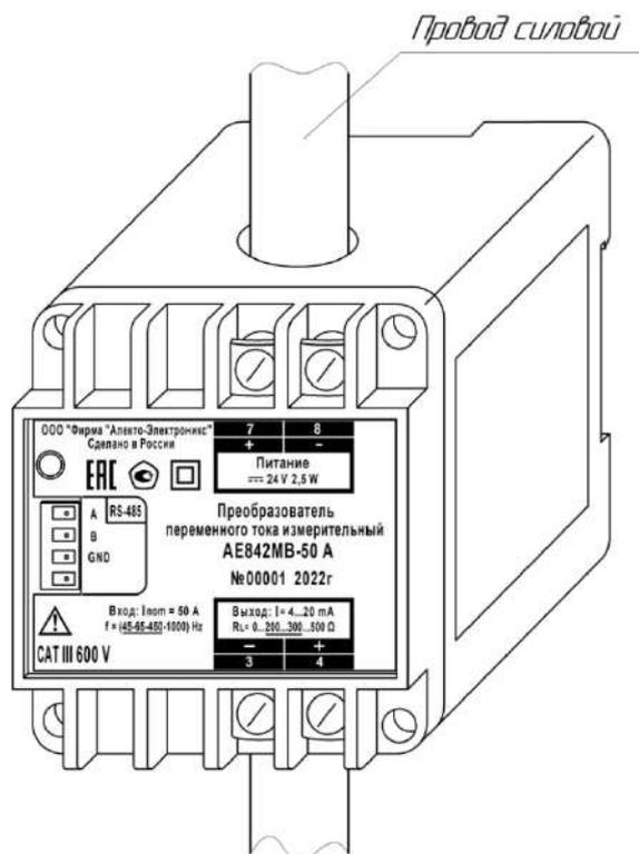
Рисунок 1.3 – Общий вид преобразователя модификации АЕ842МВ, АЕ842МС
